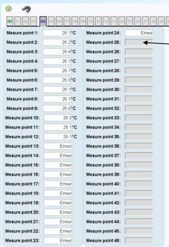
Page de mesure du module. Affichage des 46 points de mesures. ici 24 points déclarés, 12 points de mesures et 12 points en erreur.
